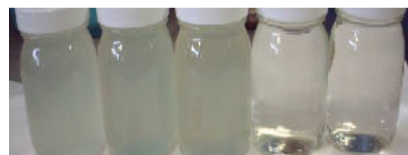
前処理槽 合併処理槽 放流槽
